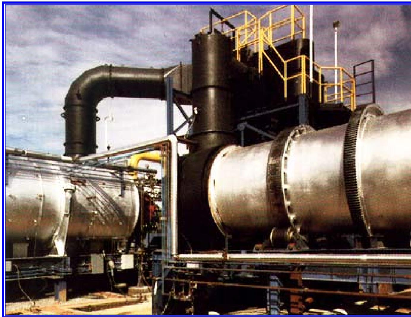
移動式旋轉窯焚化爐第二燃燒室
